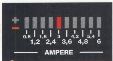
Fig.11 Se il tester misura 3 ampere e girate il trimmer R5 per accendere il led DL5, gli altri led si accendono con salti di 0,6 ampere ed il fondo scala è di 6 ampere.
